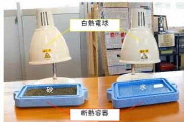
図 砂と水の比熱実験の装置
