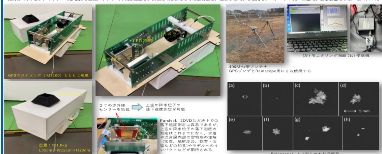
新しい降水粒子撮像ラジオゾンデ「Rainscope」の開発
