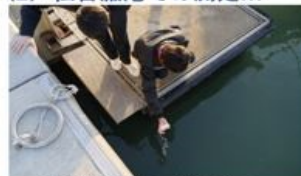
図 松合漁港での計測の様子 干潮時でも常に海水があり、 海水温の測定が可能。
