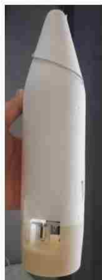
2017年台風第21号のドロップゾンデ観測結果：（中央）中心気圧の時間変化にドロップゾンデの観測値（赤い星印）を重ねたもの、（右上）接線風速と（右下）温位偏差の距離高度断面図。 （左）航空機から投下するドロップゾンデの写真（明星電気 iMDS-17）
