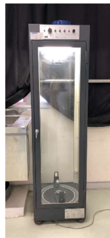
図4 実験に使用したフーコーの振り子 (1985年ウチダ社製)
